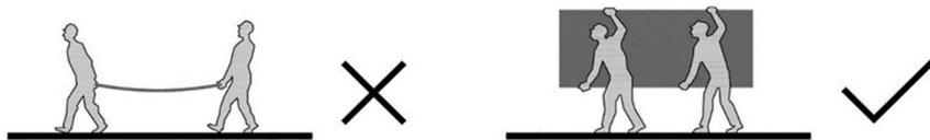
Sempre que possível, o manuseamento dos painéis deverá ser executado utilizando os equipamentos adequados, como empilhadores ou elevadores de placas.
